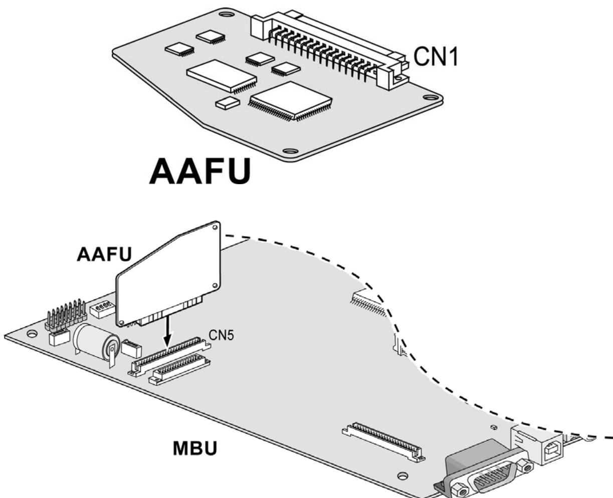
Рис. 4.5.2 Плата автоматического оператора AAFU
