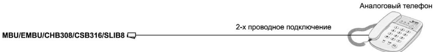
Рис 5.1.2.2 Подключение аналогового аппарата
