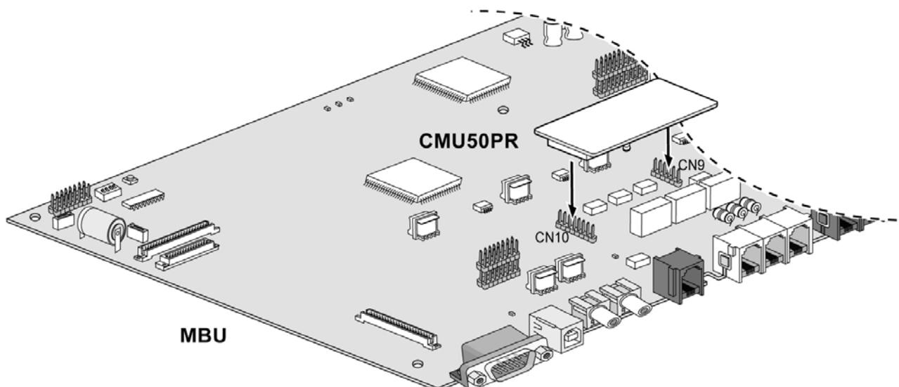
Рис. 4.5.6 Модуль определения импульсов тарификации CMU50PR
