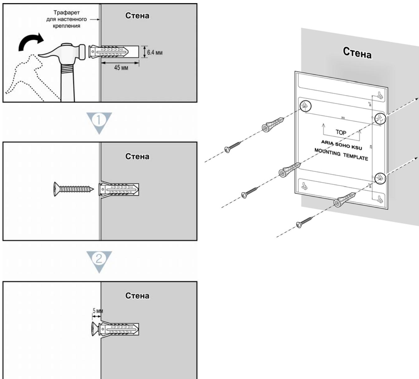
Рис. 3.2.7.1а Монтаж трафарета для настенного крепления
