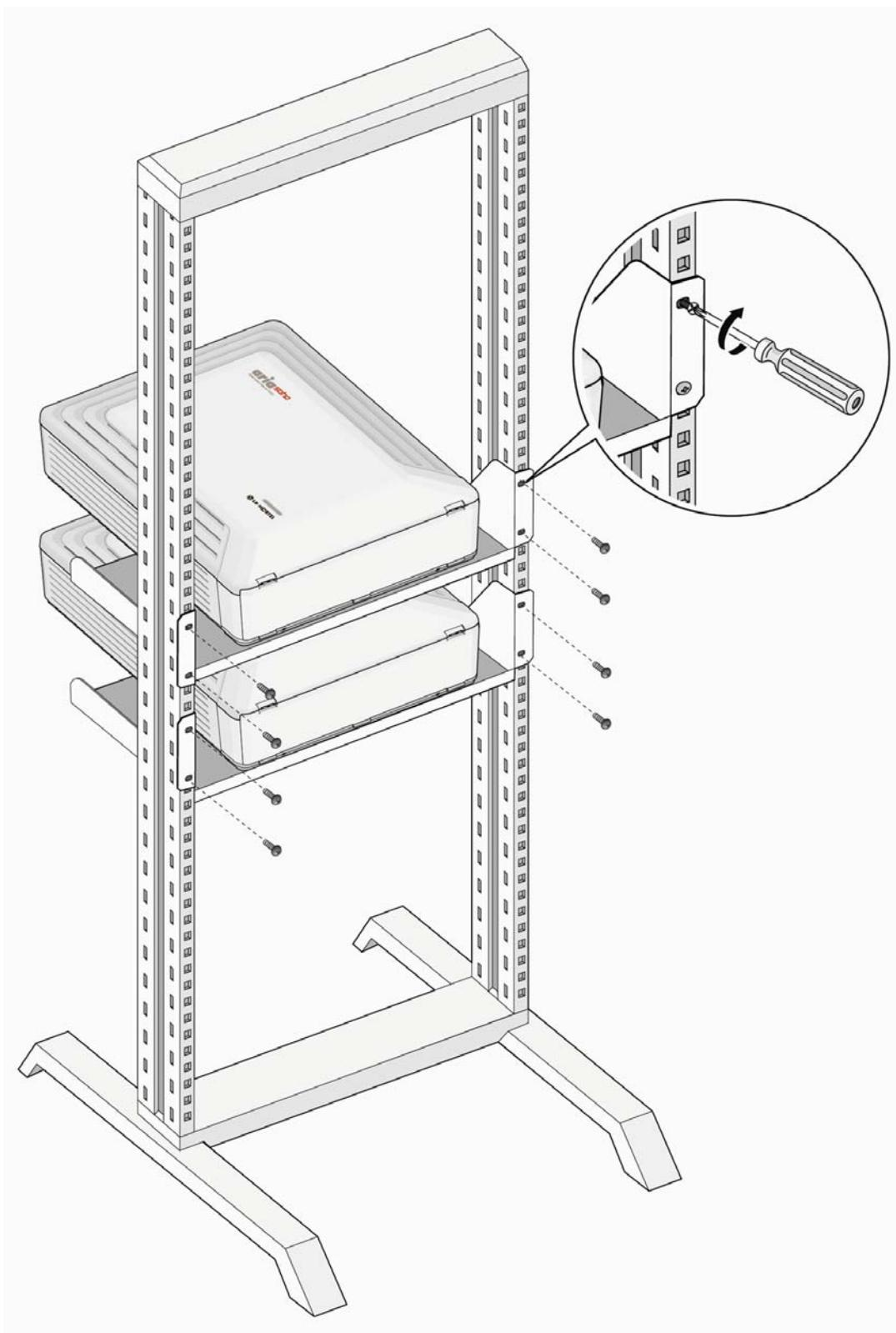
Рис. 3.3.2.2б Монтаж системного блока расширения в стойке
