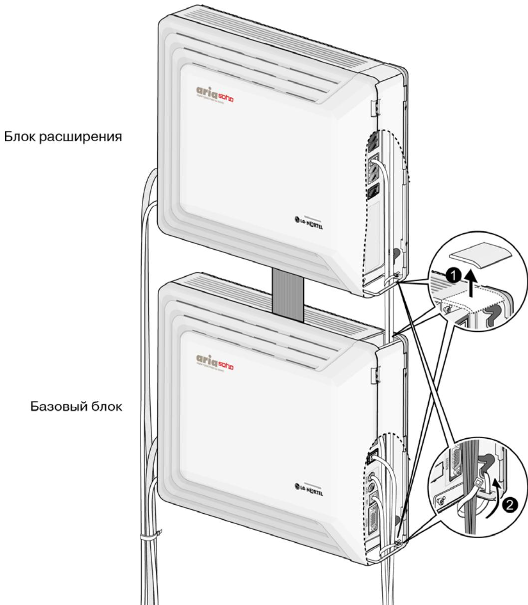
Рис. 5.2.1 Прокладка кабелей при настенном монтаже
