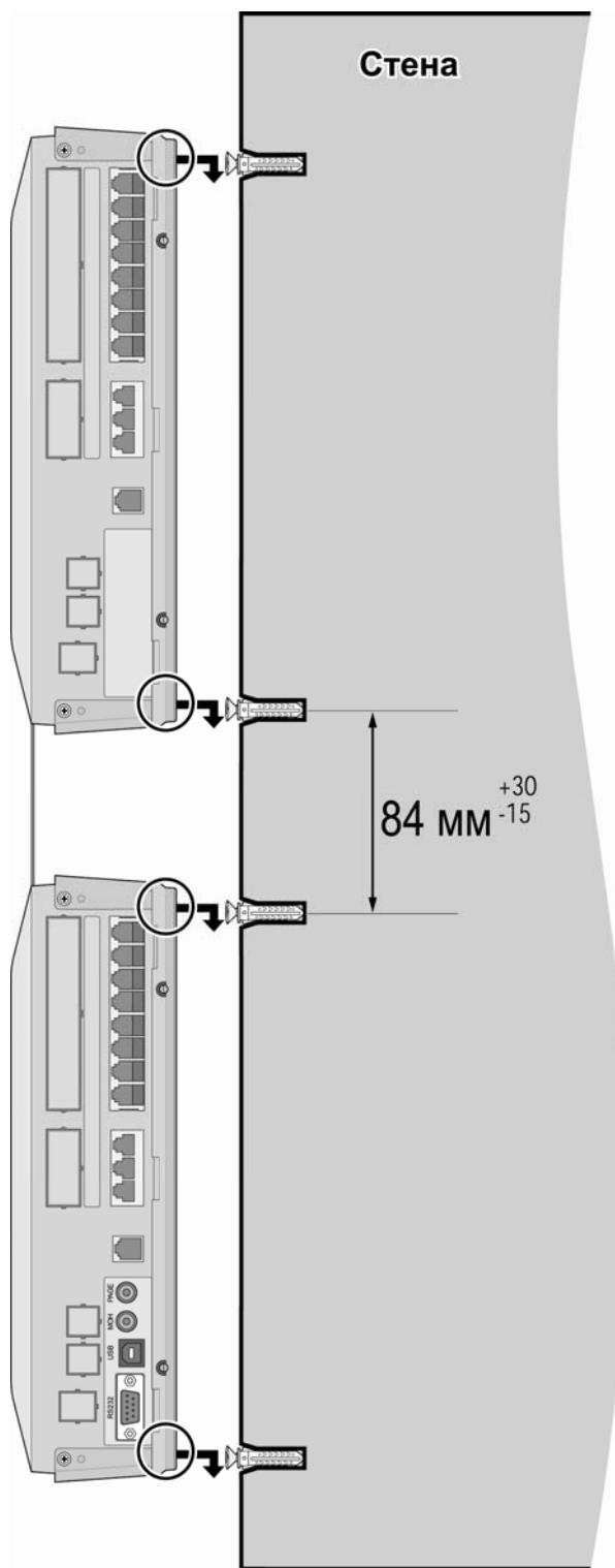
Рис. 3.3.2.1б Настенный монтаж блоков
