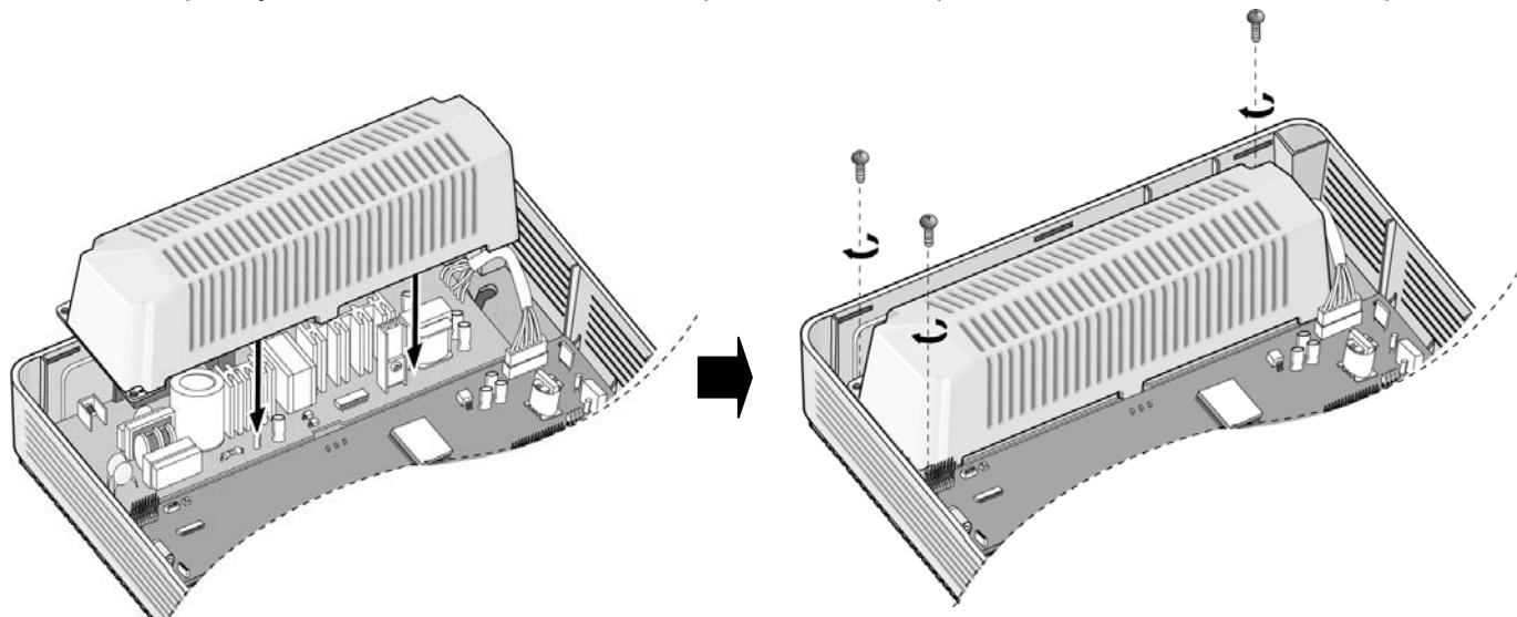
**Рис. 3.2.4б Установка блока питания**
