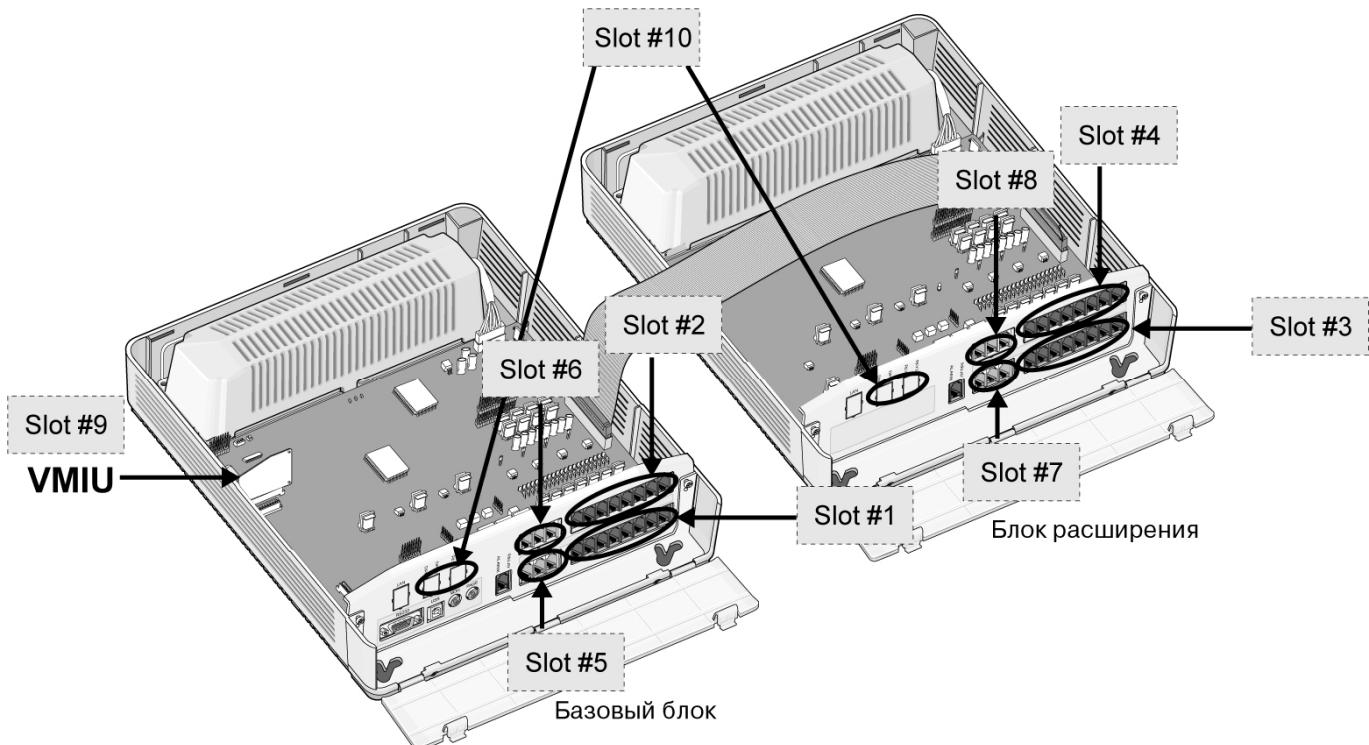
При добавлении платы или замене на другую, число портов которой не совпадает с числом портов предыдущей платы изменяется логическая нумерация портов вновь установленной платы. В этом случае назначения внешних и абонентских линий должны быть перепроверены и изменены в соответствии с новыми логическими назначениями.
