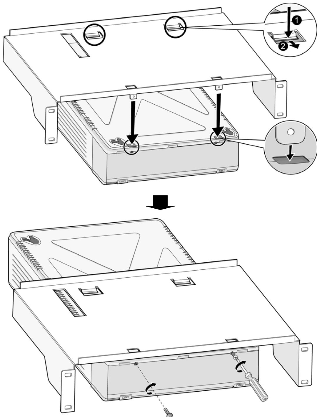
Рис. 3.2.7.26 Установка стоечного крепления
