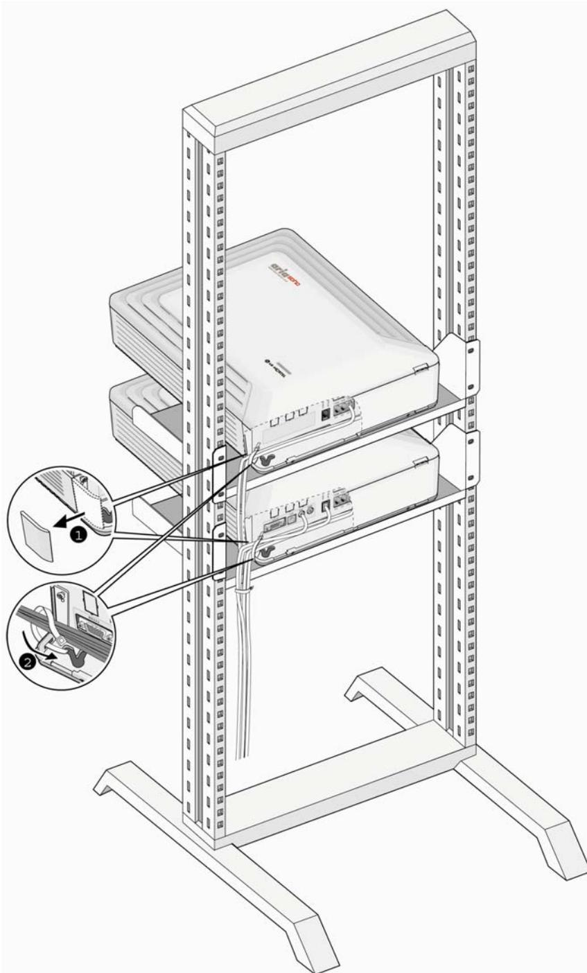
**Рис. 5.2.1 Прокладка кабелей при монтаже в стойку**
