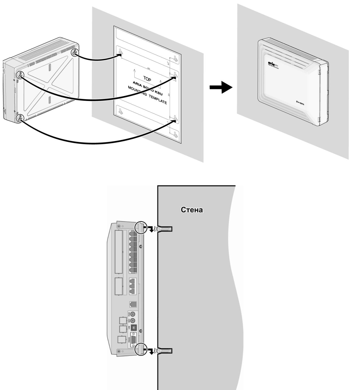
Рис. 3.2.7.16 Настенный монтаж системного блока
