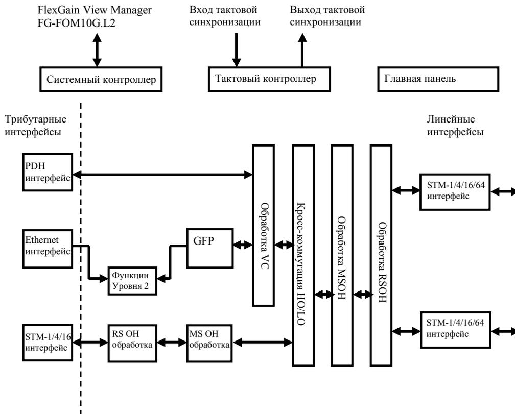
Рис 1.2. Структурная схема мультимплексора FG-FOM10G.L2
