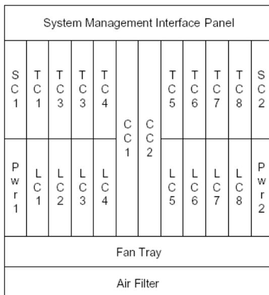
Рис. 2.1 Расположение модулей в шасси FG-FOM10G.L2
